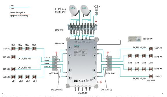
Der Einkabel-Multischalter erkennt automatisch, welchen Modus der angeschlossene Receiver benötigt und stellt das passende Signal zur Verfügung (im Einkabelmodus die Userbänder, im Legacy-Modus die jeweilige Polarisationsebene). Die Erkennung erfolgt für jeden Teilnehmerausgang separat.
