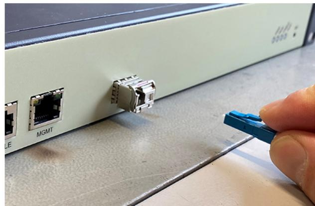
Das Glasfaserkabel entfernt man wie folgt: Den Kunststoffbügel runter drücken und den Stecker aus der Buchse ziehen. Schutzkappe nicht vergessen!
