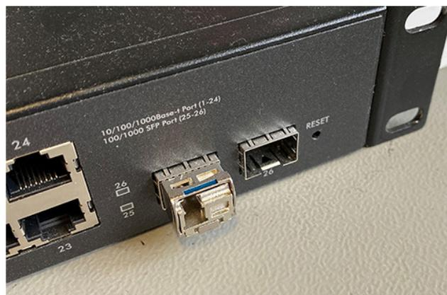
Abbildung links zeigt die fertige Verbindung zwischen Glasfaserkabel und SFPB-Modul. Die Abbildung rechts zeigt ein korrespondierendes SFPB-Modul in einem Switch (wartet noch auf die Glasfaser).
