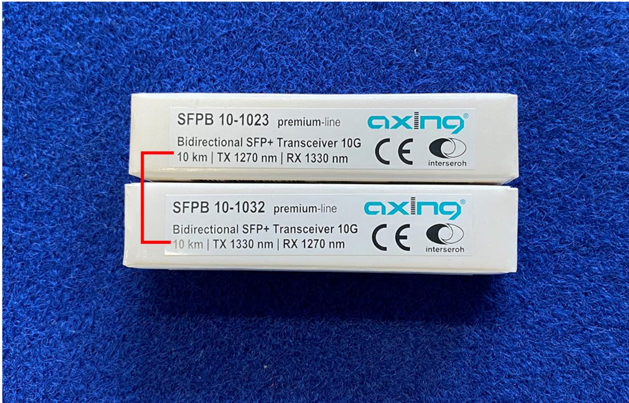
Die Abbildung zeigt zwei SFPB-Module in der Verpackung. Diese müssen korrespondieren.
