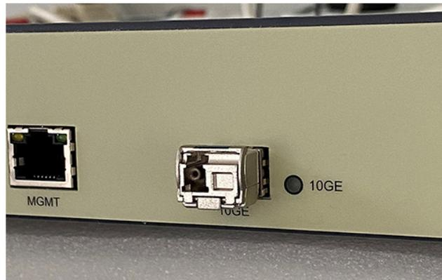
So sieht das Modul aus, wenn es in der 10 GE-Schnittstelle beispielsweise des AXING CMTS 1-00 steckt. Links noch mit Schutzkappe, rechts ohne. Wichtig: Erst unmittelbar vor dem Anschließen des Glasfaserkabels die Schutzkappen vom SFPB-Modul und vom Kabel entfernen! Sobald die Stirnfläche der Glasfasersteckverbinding auch nur ein bisschen verschmutzt wird, leidet die Übertragungsqualität.
