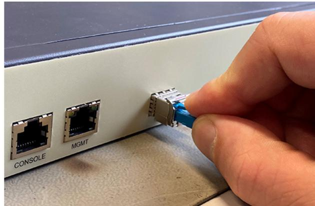
So wird das Glasfaserkabel mit dem LC/UPC-Stecker eingesteckt: Den Bügel oben runterdrücken und dann mit etwas Druck einführen.
