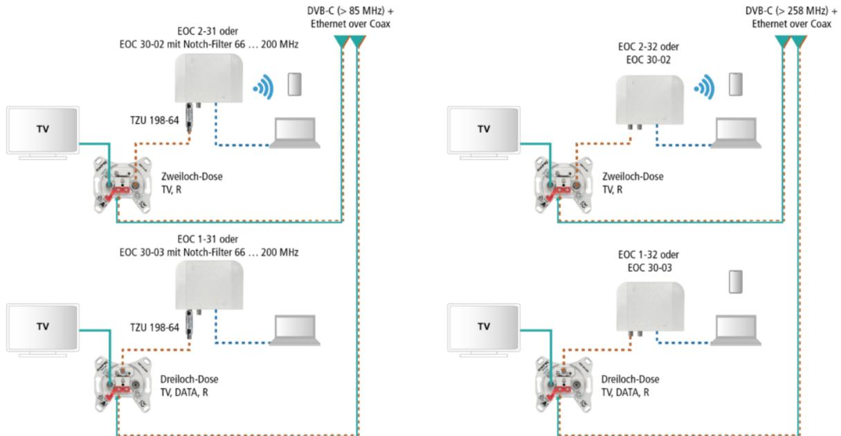
**Oben:** An der Zweilochdose (z. B. BSD 21-10) wird das TV-Gerät am TV-Anschluss angeschlossen. Am breitbandigen Radio-Anschluss (5 ... 2200 MHz) wird der G.hn-Anschluss des EOC-Geräts angeschlossen.
