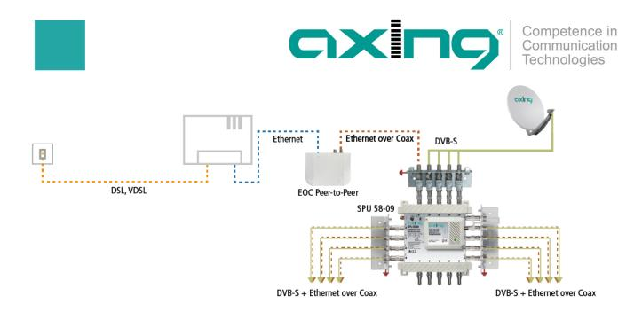
Die EOC-Signale werden über die Teilnehmerausgänge des Multischalters an die Antennensteckdosen weiter geleitet. Dort können weitere EOC-Peer-to-Peer-Modems angeschlossen werden.
