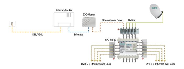
Die EOC-Signale werden über die Teilnehmerausgänge des Multischalters an die Antennensteckdosen weiter geleitet. Dort können EOC-Endpoints angeschlossen werden.
