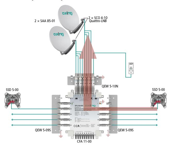
Deshalb sind AXING-Multischalter mit einer cleveren Energiesparfunktion ausgestattet. Wenn kein Receiver eingeschaltet ist, werden die LNBs nicht versorgt und es wird keine Energie verbraucht. Schaut nur ein Teilnehmer fern, wird nur der LNB versorgt, der zum Empfang benötigt wird (siehe Beispiel oben).
