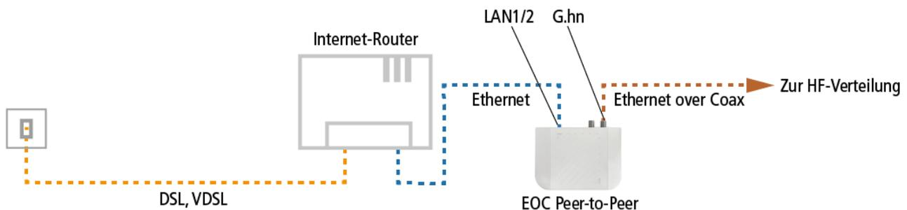
Die Verbindung zum Internet wird im Beispiel mit Hilfe des Internetrouters über DSL oder VDSL hergestellt. Das EoC-Modem wird über ein Ethernet-Kabel am Anschluss LAN1 oder LAN2 mit dem Internet-Router verbunden. Der G.hn-Anschluss des EOCs wird mit Hilfe eines Koaxialkabels mit F-Steckern mit der HF-Verteilung verbunden.
