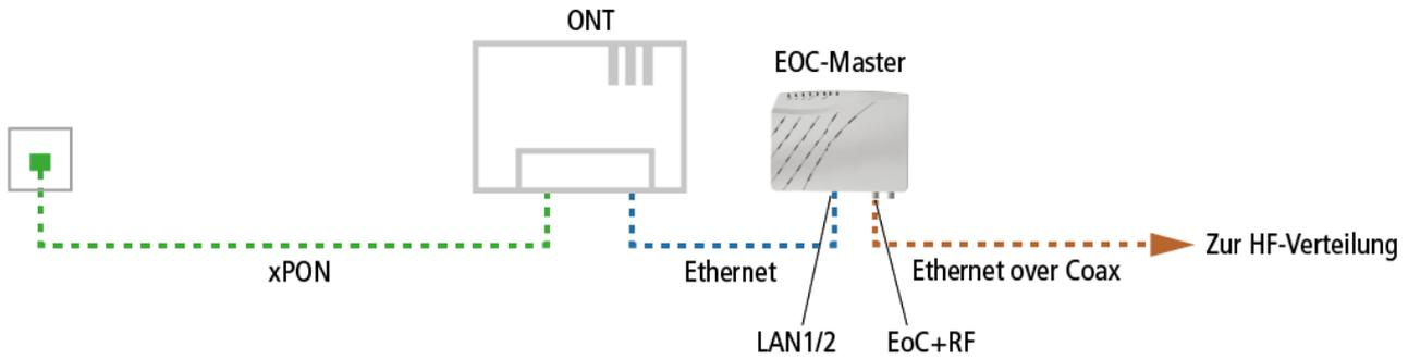
Die Verbindung zum Internet wird mit Hilfe des ONT über Glasfaser hergestellt. Das EOC wird über ein Ethernet-Kabel mit dem ONT (Optical Network Termination) verbunden.
