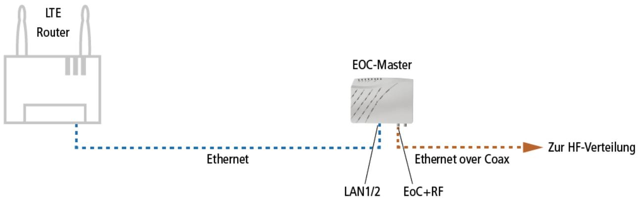
Die Verbindung zum Internet wird mit Hilfe des LTE-Routers über Mobilfunk hergestellt. Das EOC wird über ein Ethernet-Kabel mit dem LTE-Router verbunden.
