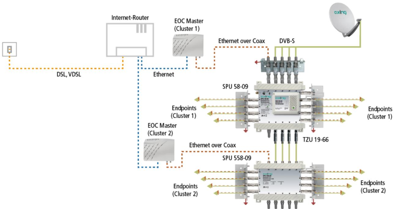
**Wichtig ist, dass die beiden EOC-Cluster HF-technische komplett getrennt sind.** Deswegen werden nur die SAT-Signale kaskadiert. Der terrestrische Zweig der Multischalter ist hingegen getrennt. Zwischen den zwei Multischaltern sollten zusätzlich 4 Rückkanalblocker eingebaut werden, um wirklich sicher zu gehen, dass die zwei EOC-Master komplett entkoppelt sind. Bei Systemen mit 1800 Mbps (5 ... 204 MHz Rückkanal) TZU 19-68X, bei Systemen mit 720 Mbps (5 ... 65 MHz Rückkanal) TZU 19-66.
